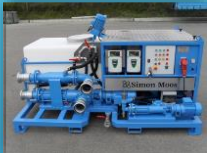
Bộ phận bơm và định lượng polyme Pumping and Polymer Dosing Unit
